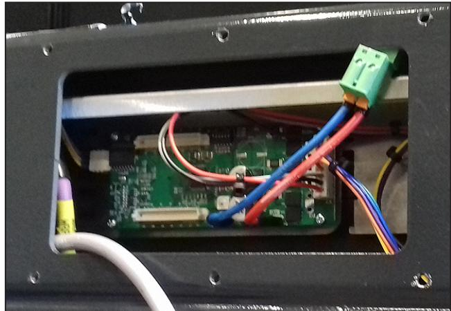
Entre la carte et l'automatisme, contrôler la résistance entre les fils :
