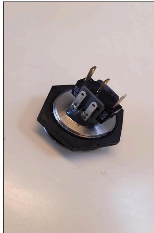
4) Vérifier qu'il n'y a pas de court-circuit entre les fils de connection du verrou et les parties métallique (vérifier au multimètre, un fil débranché).
