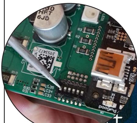
... vérifier la bonne position des Switches qui doivent être comme indiquer sur le schéma ci-dessous.
